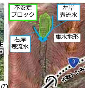
高度化された点検手法の例 レーザープロファイラ調査
